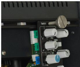
Ziehen Sie Module immer Hilfe von 4 mm Schrauben aus dem Träger heraus.
