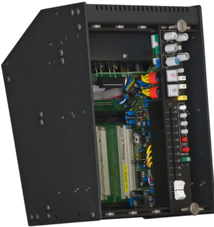
Vergewissern Sie sich vor dem Einschalten nach dem Einbau von Modulen, dass die Module korrekt in den Gegensteckern im Rahmen eingesteckt sind und dass die Frontplatten im Rahmen angeschraubt sind.
