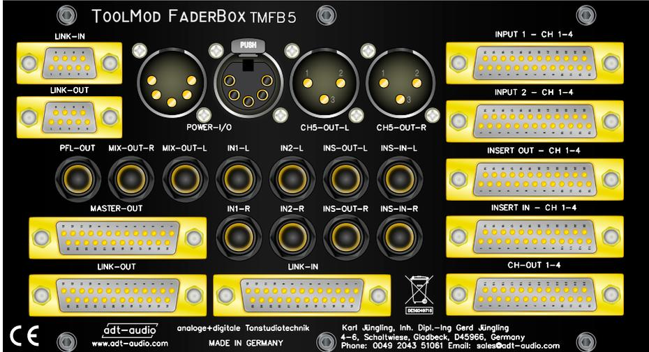
Der 10-Zoll Rahmen verwendet 25-polige D-Sub Buchsen für die Ein- und Ausgänge der Modulplätze 1 bis 4 und TRS-Klinken (1/4-Zoll Stereo-Klinke mit symmetrischer Belegung) sowie XLR-Einbaustecker für den fünften Modulplatz. Die Anschlussbelegungen der XLR- und TRS-Steckverbinder finden Sie auf der Seite 15.
