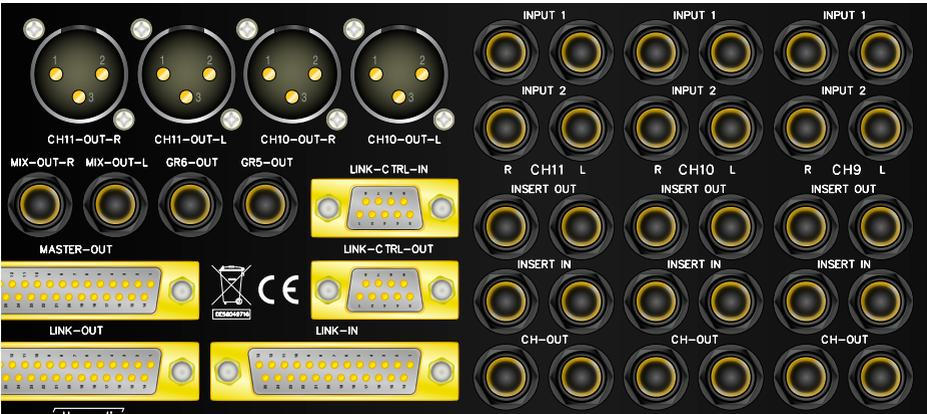
Alle Anschlüsse für die Modulplätze 9 bis 11 liegen auf einzelnen TRS-Buchsen auf. Die Anschlüsse sind für Stereo-Eingangsmodule ausgelegt. Beim Einbau von Mono-Eingangsmodulen werden nur die Buchsen für die linken Stereokanäle verwendet. Für die Ausgänge der Modulplätze 10 und 11 sind zusätzlich und parallel zu den TRS-Buchsen XLR-Einbaustecker vorhanden.
