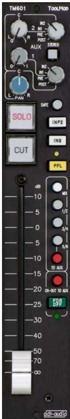
Die Standardversion des TM601 Mono Eingangsmoduls verwendet ein Pan-Pot mit einer Mittendämpfung von 3 dB. Alternativ kann das Pan-Pot mit 0 dB Mittendämpfung ausgeführt werden. Wenn die Faderbox überwiegend als Summierer verwendet wird, bietet diese Version den Vorteil, dass keine Pegelveränderung in der Mittelstellung stattfindet und in der DAW eingestellte Pegelverhältnisse unabhängig von den Einstellungen der Pan-Pots unverändert auf die Faderbox übertragen werden.
