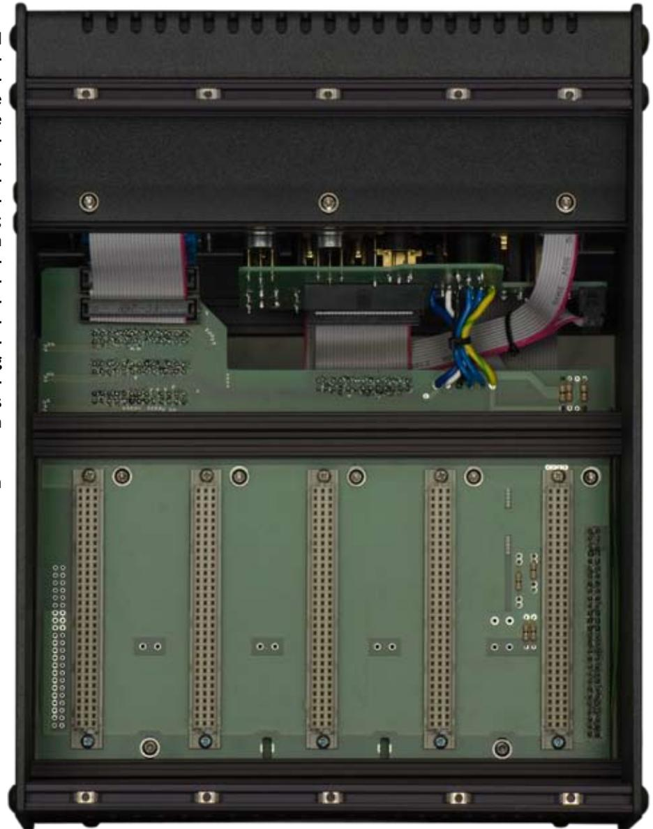
Das Foto rechts zeigt den Blick auf das Motherboard einer 5-Kanal Faderbox. Links oben ist ein Rahmen mit einem einzelnen eingebauten Modul abgebildet. Das Foto daneben zeigt ein Modul im ausgebauten Zustand.
