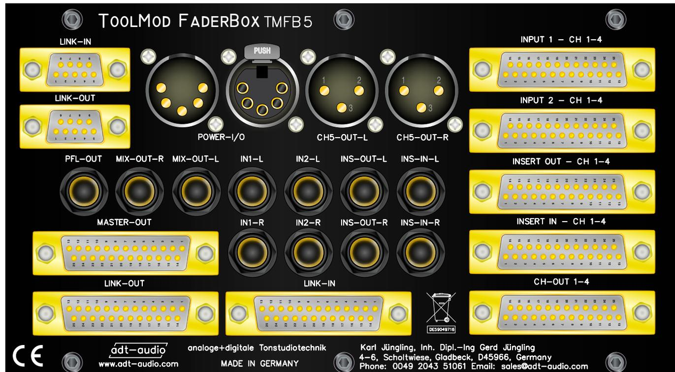
Die Ausgänge der internen Summenverstärker und die Link-Ein- und Ausgänge liegen, wie bei allen Faderbox-Versionen, auf drei 25-poligen D-Sub-Buchsen auf. Die Anschlüsse für die Link-Steuerungs-Ein- und Ausgänge liegen auf zwei 9-poligen D-Sub-Buchsen auf. Zum Anschluss der Stromversorgung dienen 5-polige XLR-Verbindern, die identisch mit allen anderen Geräten der Tool-Baureihen von adt-audio ausgeführt sind.
