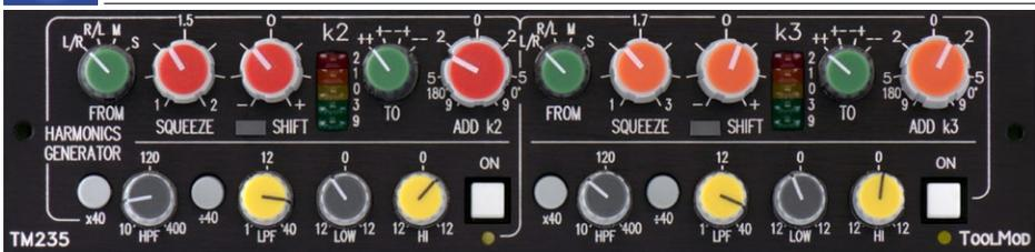
Pegel der Harmonischen bei kleineren Pegeln leicht an. Mit **SQUEEZE** regeln Sie das Kompressionsverhältnis (Ratio) der **Stereo-Kompressoren**, die vor den Multiplizierern angeordnet sind. Durch diese Regelung können Sie den Effekt in weiteren Grenzen beeinflussen. Die Grafik auf der vorherigen Seite zeigt die Abhängigkeit des Klirrfaktors vom Eingangspiegel bei verschiedenen Einstellungen des **SQUEEZE**-Reglers im k3-Generator. Der Squeeze-Regler des k2 Generators arbeitet analog.
