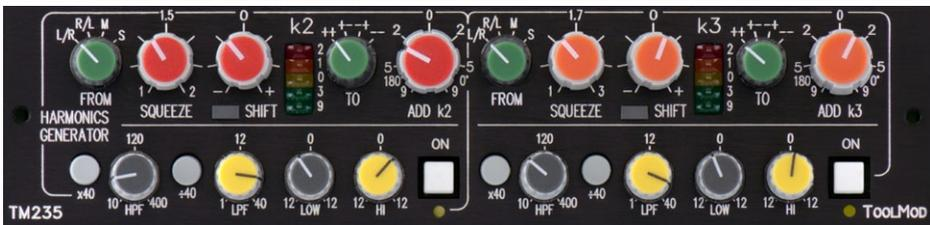
3<sup>2</sup>. Ein um 6 dB geringerer Eingangspegel reduziert den Pegel der Harmonischen um 18 dB; der Klirrfaktor verringert sich auf 1/8 des ursprünglichen Wertes.
