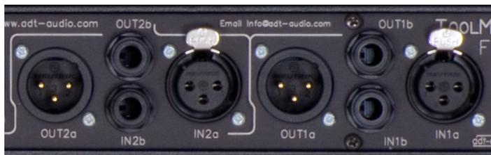
Die Belegungen beim Einbau in einen 4HE-Rahmen sind identisch. Die Anschlüsse für den linken Kanal sind hier unten angeordnet, die des rechten Kanals oben.
