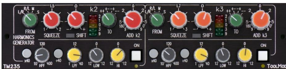
Pegel 10 bis 20 dB geringer ist als in den anderen Stellungen. In dieser Stellung wird nur der Raumteil des Stereosignals verwendet, der, abhängig von der Räumlichkeit des Signals einen deutlich geringeren Pegel hat. Korrigieren Sie den geringeren Pegel mit dem Regler SHIFT.
