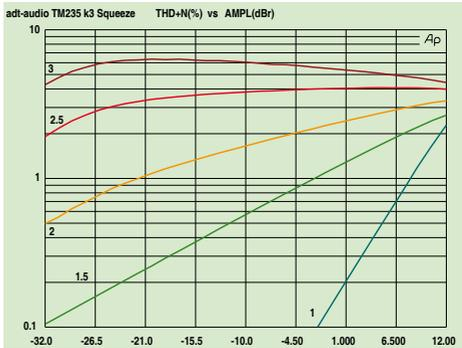
Die Grafiken zeigen die Abhängigkeit zwischen Eingangspegel und Klirrfaktor bei verschiedenen Einstellungen des **SQUEEZE**-Reglers für den k2- und den k3-Generator.
