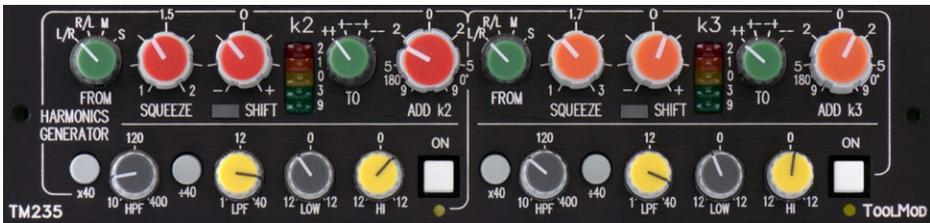
Je nachdem ob Sie den Harmonics-Generator für Feinarbeiten beim Mastering oder für drastische Verfärbungen bei der Bearbeitung von Einzelsignalen oder Subgruppen verwenden benötigen Sie unterschiedliche Regelbereiche. Sie können den gesamten Regelbereich einfach durch die **SHIFT**-Regler in beide Richtungen verschieben.
