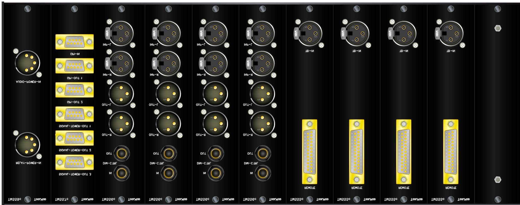
Die Abbildung zeigt das Anschlussfeld des voll bestückten TM550 Systems mit den vier Anschlussplatten für die Sprechstellen-Interface-Module TM55, den vier Anschlussplatten für die Stereo-Audio-Module TM556, die Anschlüsse für das Lichtsteuermodul TM557 und die Stromversorgung.
